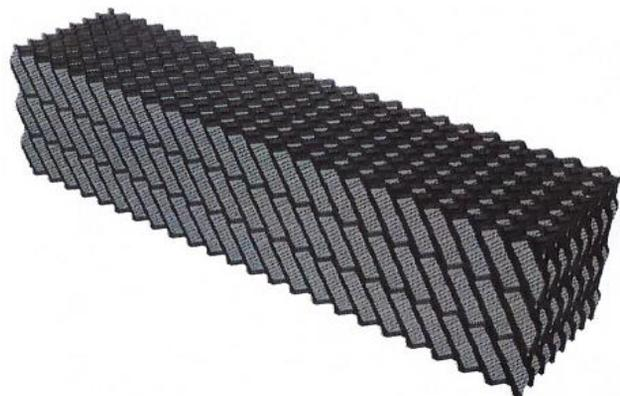
Il pacco di riempimento **FM19** ha l'altezza del profilo termoformato di 19 mm. Il disegno dei fogli è di tipo incrociato con canaline inclinate di 60° rispetto all'orizzontale che presentano una sezione d'imbocco alta 38 mm (19 + 19 mm).
