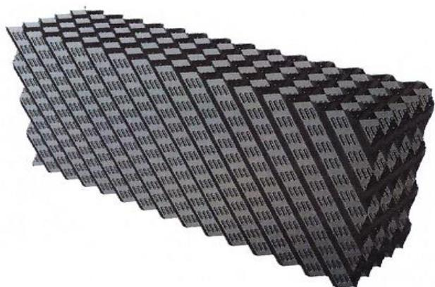
Il pacco di riempimento **FM27** ha l'altezza del profilo termoformato di 27 mm. Il disegno dei fogli è di tipo incrociato con canaline inclinate di  $60^\circ$  rispetto all'orizzontale che presentano una sezione d'imbocco alta 54 mm (27 + 27 mm). I pacchi FM27 hanno un rapporto di superficie di scambio pari a  $115 \text{ m}^2/\text{m}^3$ . La distanza massima degli appoggi è di 600 mm.
