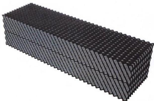
Il pacco di riempimento **FM12** ha l'altezza del profilo termoformato di 12 mm. Il disegno dei fogli è di tipo incrociato con canaline inclinate di 60° rispetto all'orizzontale che presentano una sezione d'imbocco alta 24 mm (12 + 12 mm).
