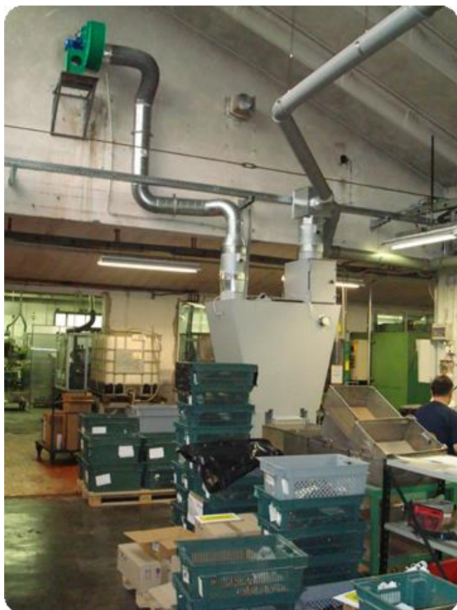
Sistema filtrante a carboni attivi su un impianto di stampaggio plastica
